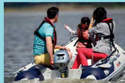
Der BF2.3 ist luftgekühlt und reduziert dadurch die Wartungskosten.
