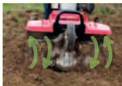
Gegenläufiger Hacksatz (Abbildung FF500)
