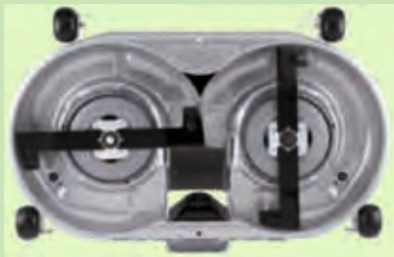
Aufbau des Mähdecks mit nicht synchron-laufenden Messern
